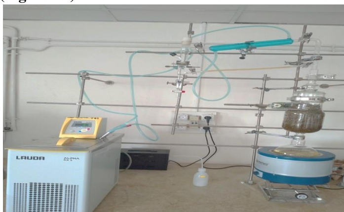
Figure 6 : Principe de distillation a la vapeur (Photo personnelle : Laboratoire de chimie pharmaceutique, Université Constantine1)
