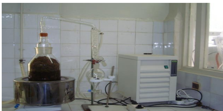
Figure 5: Montage d'extraction par la technique d'hydrodistillation (Atmani-Merabet, 2018)
